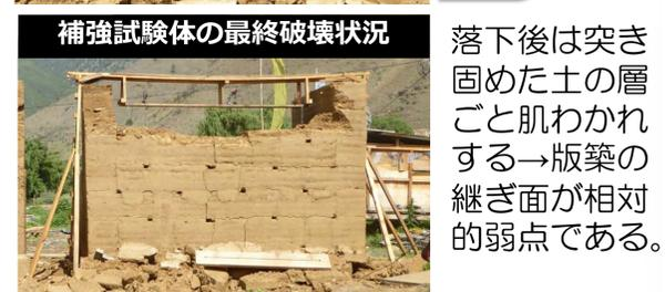
落下後は突き固めた土の層ごと肌わかれする→版築の継ぎ面が相対的弱点である。
