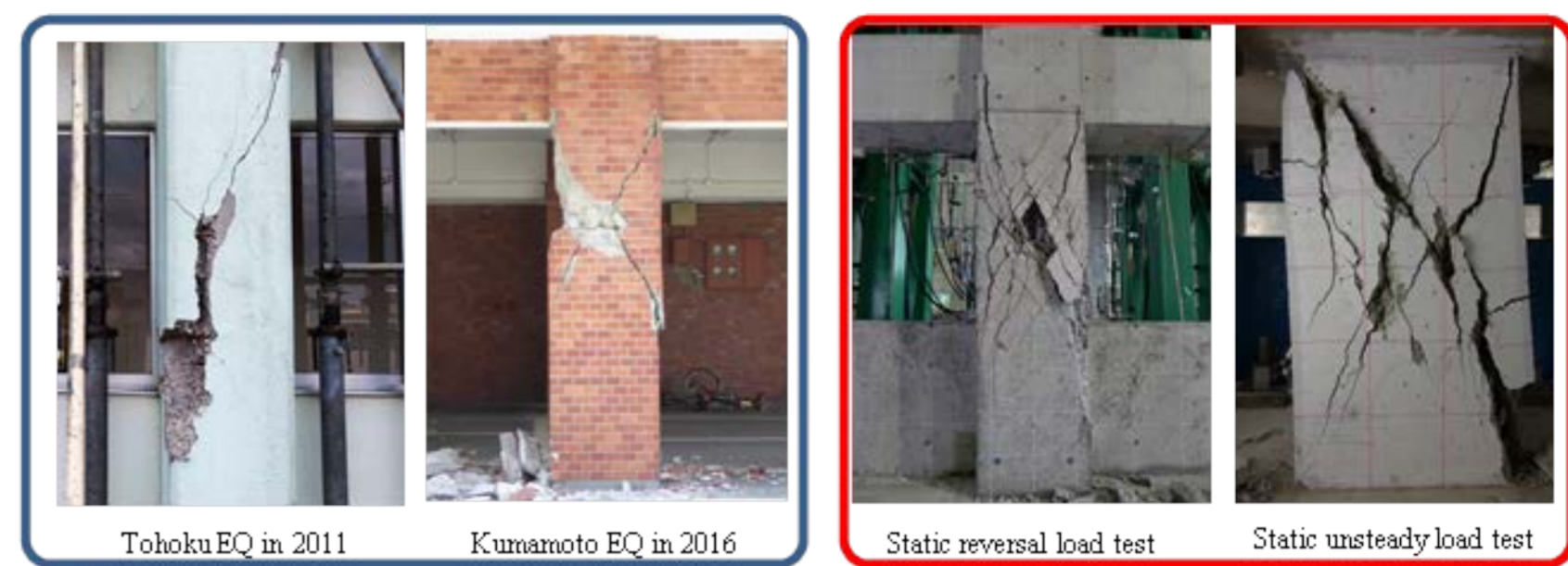
→ 動的載荷・実地震では損傷限定... → 静的載荷実験では多数ひび割れ発生
