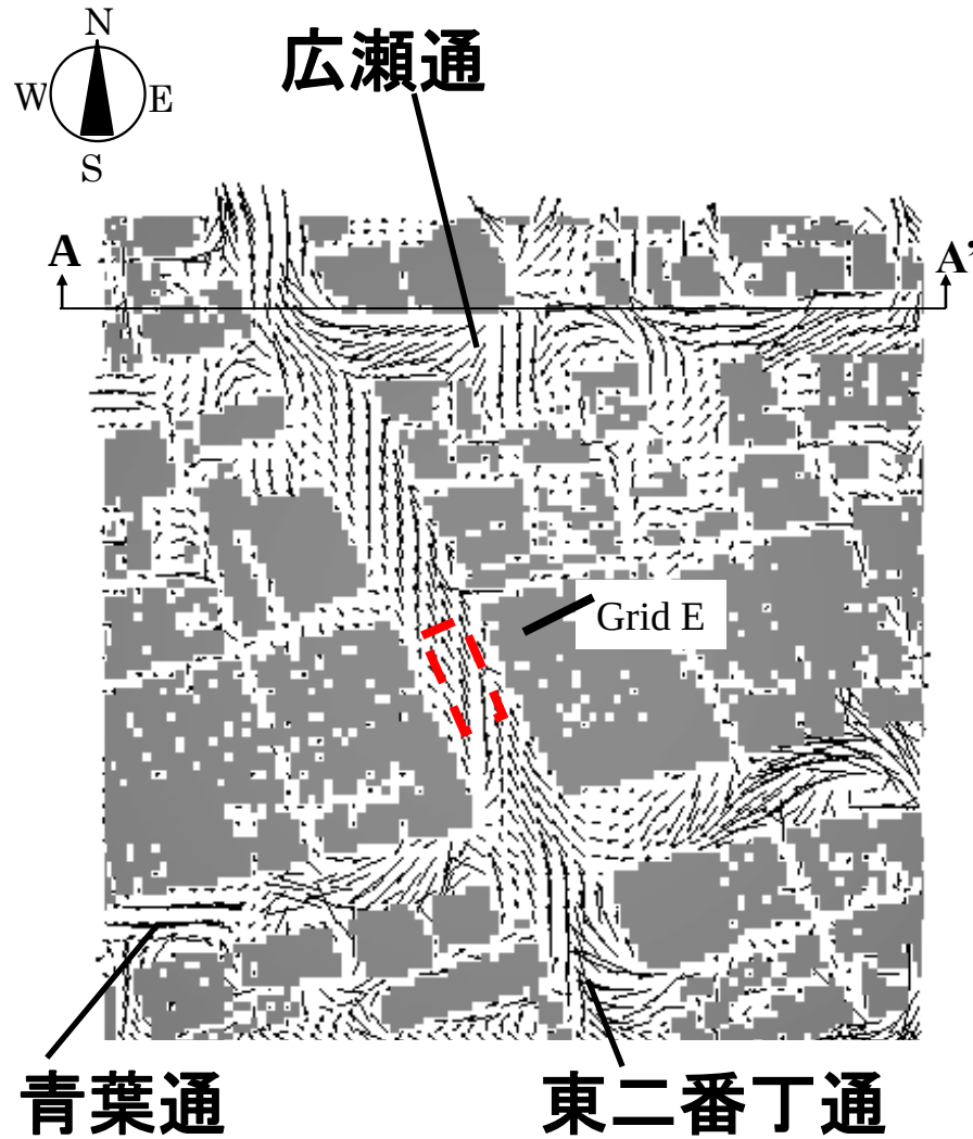
(1) 風速ベクトルの水平分布(高さ1.5m)
