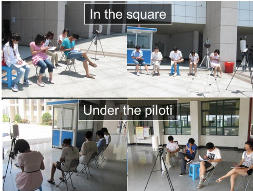
武漢における日中共同での屋外温熱環境実測 と被験者アンケート
