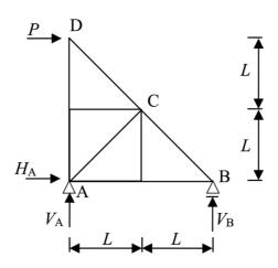
B. 下図のような水平力 P を受ける静定架構について、支点反力 $H_A$ , $V_A$ ,  $V_B$ ,  $V_D$ を求めなさい。また、曲げモーメント図とせん断力図を描きなさい。点 C はヒンジである。(20 点)
