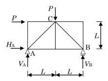
(2) 下図のような水平力 P を受けるラーメンについて、支点反力  $V_{\rm A}$ ,  $V_{\rm C}$ ,  $H_{\rm C}$  を求めなさい。また、曲げモーメント図を描きなさい。
